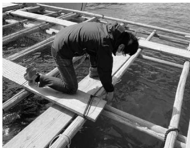
志摩半島・英虞湾の養殖筏の水面下に水質の連続観測ができるデータロガーを設置（東北大院三橋正枝助教提供）
